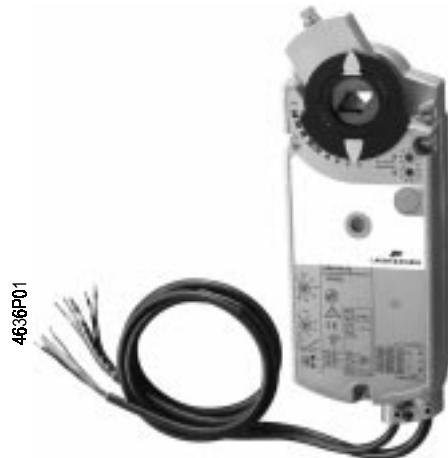
**Elektrické rotační servopohony, jmenovitý krouticí moment 35 Nm, napájecí napětí 24V~, spojity řídící signál 0...10V=, zpětnovazební výstupní signál pro indikaci polohy 0...10V=, pracovní rozsah mechanicky nastavitelný mezi 0...90°, zapojené připojovací kably o délce 0,9 m.**
